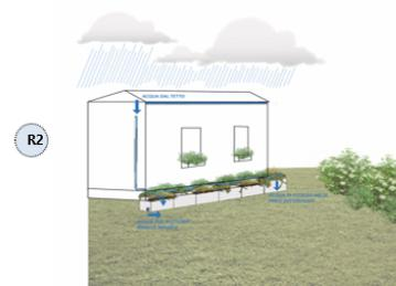
Realizzazione di cisterne- vasche interrate per la raccolta e riutilizzo delle acque meteoriche provenienti dalle falde dei tetti: scavo e inserimento di vasca sotterranea per la raccolta delle acque provenienti dalla gronda; la cisterna è fornita di una pompa per il riutilizzo dell'acqua raccolta per usi privati di irrigazione( orto, giardino, ...).
